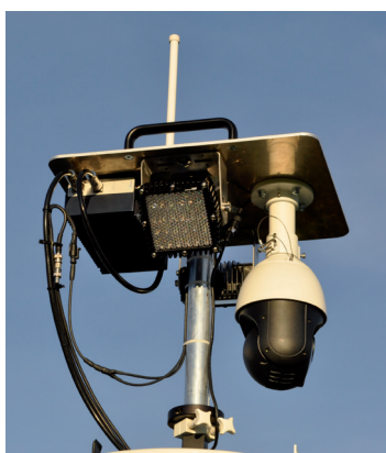
Mastkopf mit konfigurierbarer Trägerplatte. (Bild: VITES GmbH)
